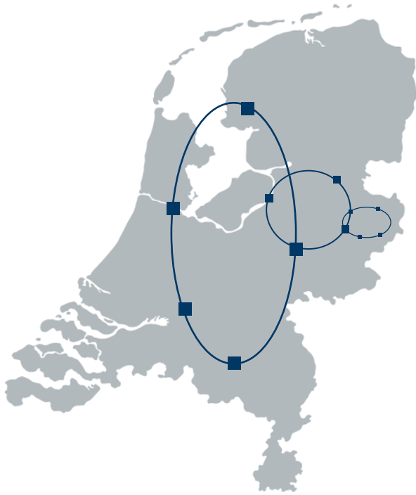
Figuur 3. Schematische weergave van één nationale, één regionale en één lokale glasvezelring
